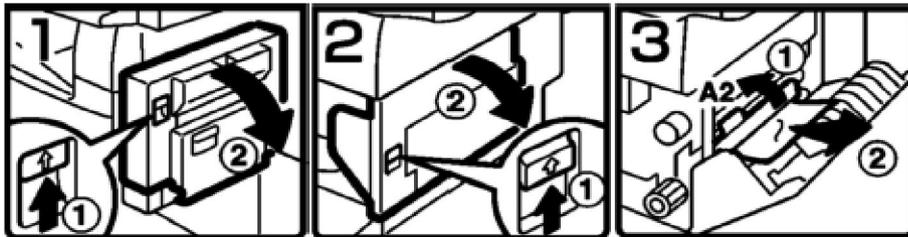
Nhấn chốt (1) trên Duplex (H1) bên phải máy, mở khối Duplex (2) theo chiều mũi tên. Tương tự (H2) , nhấn chốt (1) để mở cửa bên phải của máy (2) theo chiều mũi tên. Kéo thanh (A2) (1) qua trái (H3) , kéo giấy kẹt (2) ra ngoài. Mở (H4) cửa nhỏ bên phải, phía dưới (hoặc LCT nếu có). Xoay bánh xe (A1) (H5), giấy sẽ được đẩy lên trên
