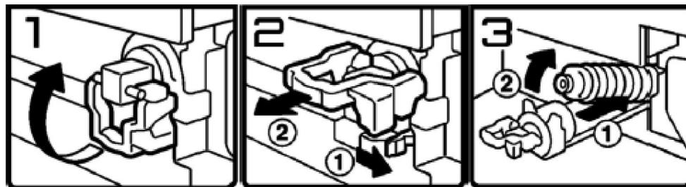
Mở cửa trước , kéo cần khóa (H1) màu xanh lá lên . Nhấn (H2) chốt (1) về bên phải , kéo khối bơm mực ra (2) . Đẩy lùi (H3) ống mực cũ vào trong (1) , nhấc đầu ống mực lên và lấy ra khỏi máy .
