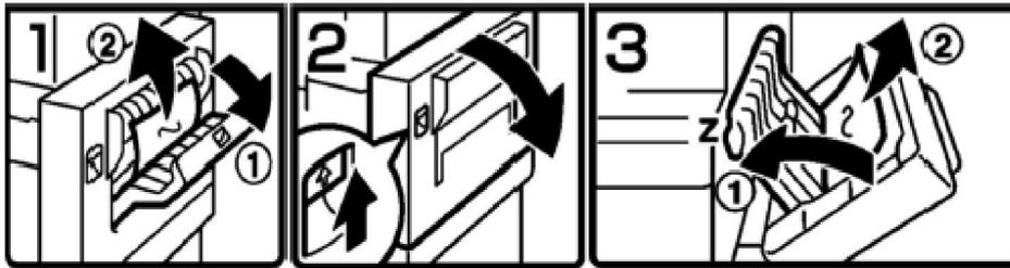
Mở cửa bên phải (H1) của Duplex (1) theo chiều mũi tên, lấy giấy kẹt ra khỏi Duplex (2). Nhấn chốt trên Duplex (H2) bên phải máy, mở khối Duplex theo chiều mũi tên. Mở (H3) lá (Z) của Duplex (1) theo chiều mũi tên, lấy giấy kẹt ra khỏi Duplex (2).
