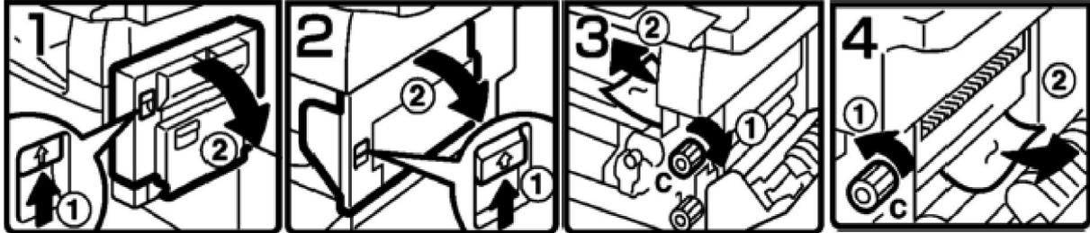
Nhấn chốt (1) trên Duplex (H1) bên phải máy, mở khối Duplex (2) theo chiều mũi tên. Tương tự (H2), nhấn chốt (1) để mở cửa bên phải của máy (2) theo chiều mũi tên. Xoay (H3) nút B theo chiều kim đồng hồ (1) để đẩy giấy kẹt ra (2) khay chứa giấy . Hoặc (H4) xoay nút C ngược chiều kim đồng hồ (1) để đẩy giấy ra cửa bên phải (2).
