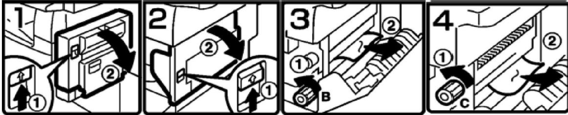
Nhấn chốt (1) trên Duplex (H1) bên phải máy , mở khối Duplex (2) theo chiều mũi tên. Tương tự (H2) , nhấn chốt (1) để mở cửa bên phải của máy (2) theo chiều mũi tên. Xoay (H3) nút B theo chiều mũi tên (1) để đẩy giấy kẹt ra ngoài (2) . Nếu giấy kẹt tại bộ phận sấy (H4) , xoay nút C theo chiều mũi tên (1) để đẩy giấy kẹt ra ngoài (2) .
